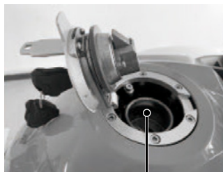
Entrada del depósito
